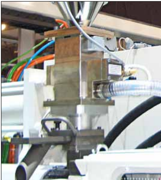
Système PROTECTOR PRIMUS installé à l'entrée matière d'une machine à injection
