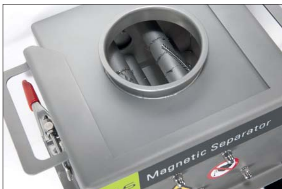
Le contact optimal entre le produit pulvérulent et l'aimant améliore le niveau de séparation.
